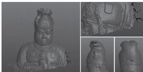
> 图12 扫描完成后依旧留有的漏洞-制图王冬梅
