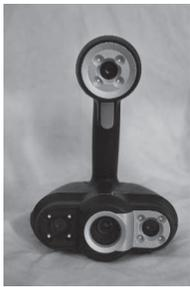
> 图2 GO!SCAN 50三维扫描仪简介图-制图王冬梅
